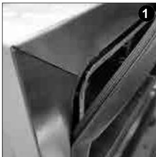
Все модели печей оснащены уплотнителями, которые легко снимаются для проведения очистки или замены. Регулярно проверяйте целостность уплотнителя дверцы.
